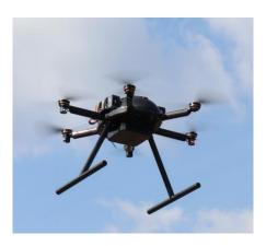
「空飛ぶクルマ」の飛行を実現するため、飛行時における衝突防止自動管制技術「AURORA」をドローンシステムに搭載し、衝突回避試験と、20km圏内で飛行する航空機を、MR(仮想世界と現実世界を融合)技術を用いて見える化する実証実験を実施しました。
